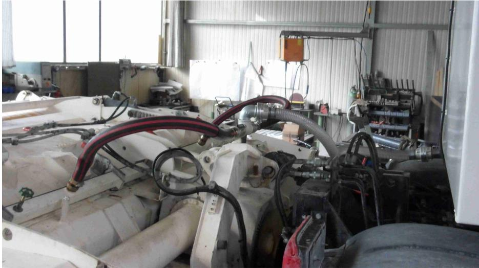
**Absperrbare Einsprühanlage mit Durchflussmengenmesser und exakter Dosierung.**
