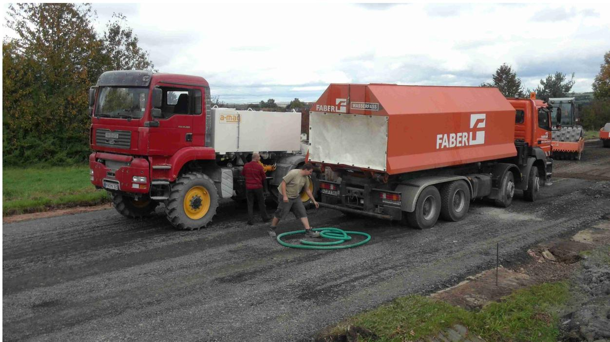
**Füllen des 8 m<sup>3</sup> Tanks von einem a-mag Abrolltank AT 23 mit 23 m<sup>3</sup> Inhalt.**
