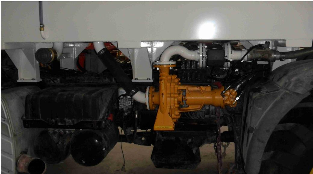
**Pumpeneinbau mit digitalem Durchflussmesser zur präzisen Eindüsung direkt in den Mischraum.**
